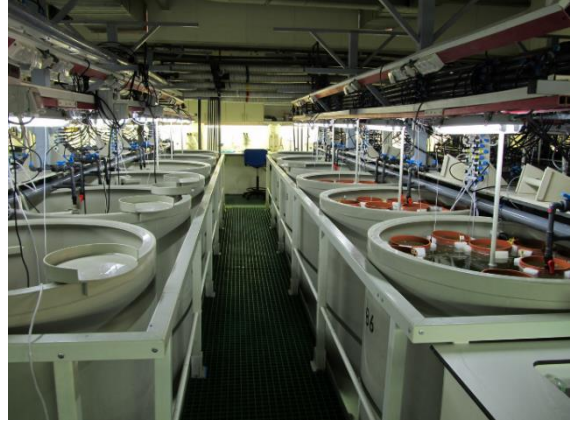
Figura 3. Sistema experimental de 18 tanques de 1,5 m3 en el IOLR.
