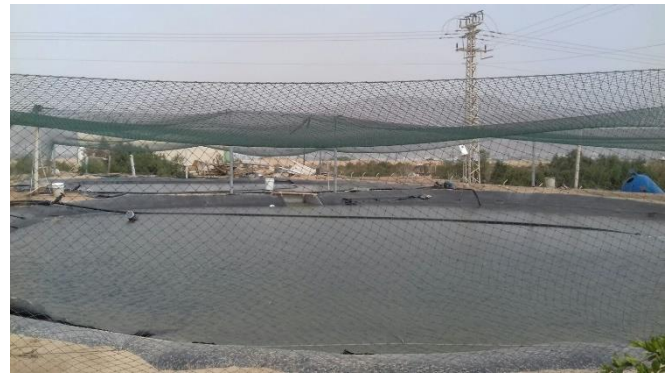
Figura 14 Tanques forrados de PVC para engorde de lisas en el IOLR con redes para detener la depredación por aves.
